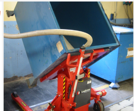
Hauteur de travail optimale pour le remplissage et vidage de caisses, aussi bien assis que debout.
