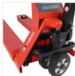
L'angle de rotation du WSP 2200 est de 210° pour faciliter les opérations même dans les endroits restreints.
