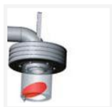
Clapet antichute Pour éviter les accidents la charge et l'unité de levage s'arrêtent ou descendent lentement en cas de défaut de vide dû à une coupure de courant ou à une défaillance de la pompe, par exemple. On évite ainsi de blesser l'utilisateur et d'endommager les marchandises.
