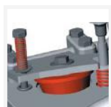
Retour automatique La charge revient toujours à la hauteur programmée, lorsque l'utilisateur relâche la poignée de commande.
